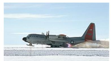
Un *LC-130* realizando un despegue asistido por cohetes sobre una superficie nevada.
