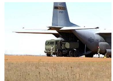
Un C-130 descargando un camión lanzamisiles HIMARS.
