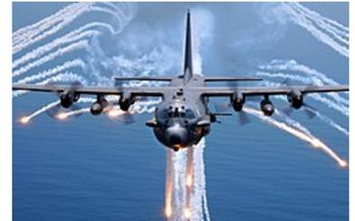
Un avión artillado *AC-130H Spectre* lanzando bengalas, esta versión está armada con un cañón automático Bofors de 40 mm L/60 y un obús M102 de 105 mm.
